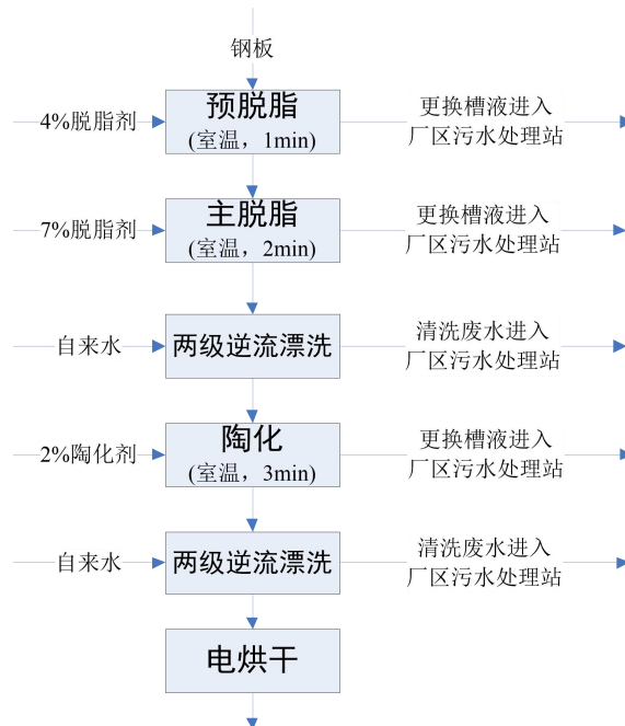
图 3-7 脱脂陶化预处理工艺流程及产污环节
